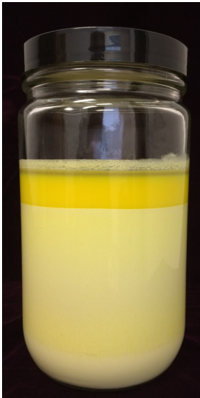
Barbotine primaire standard après avoir été laissée au repos pendant 24 heures
